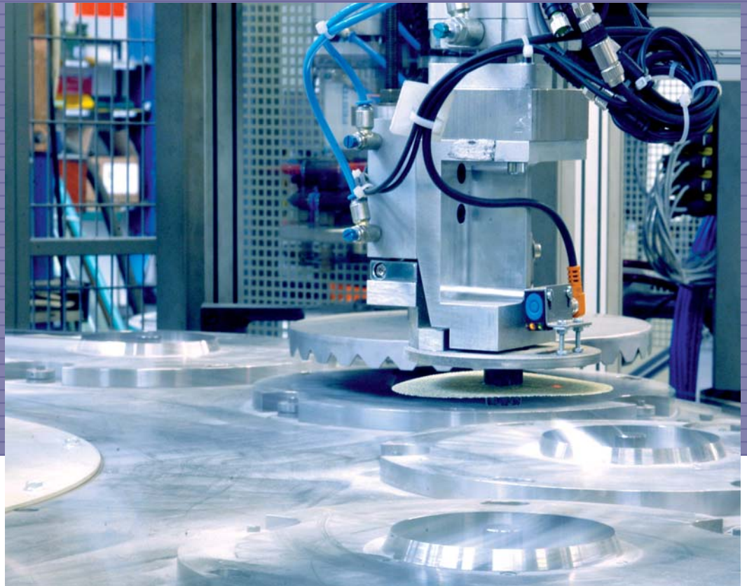
Unten: Automatisch werden nach jeder Drehung des Tisches Etiketten eingelegt.
